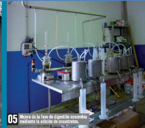
**05** Mejora de la fase de digestión anaerobia mediante la adición de cosustratos.
