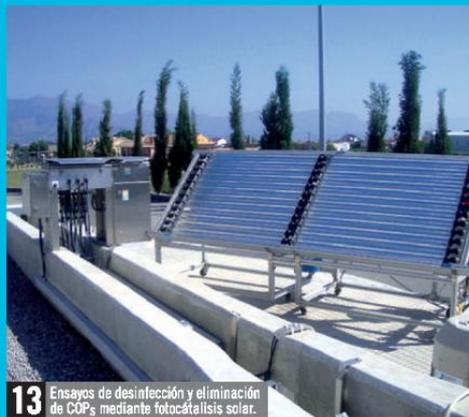
**13** Ensayos de desinfección y eliminación de COPs mediante fotocátalisis solar.
