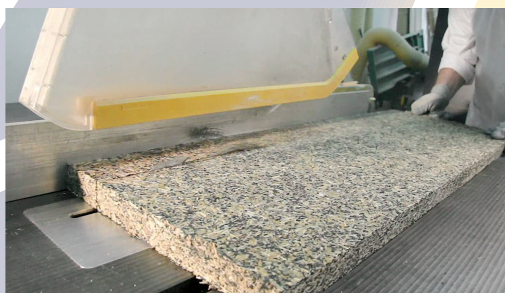
Mecanizado de un tablero de madera y caucho reciclados.
