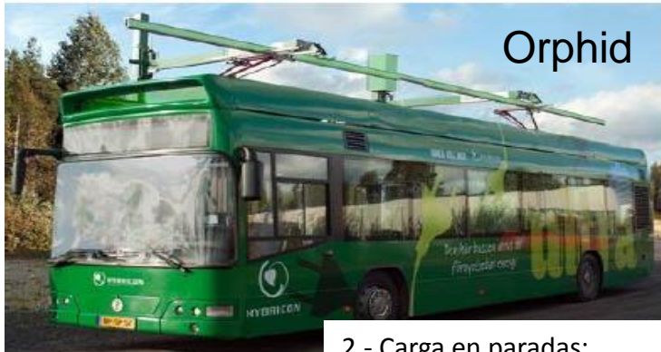
2.- Carga en paradas: conductiva e inductiva
